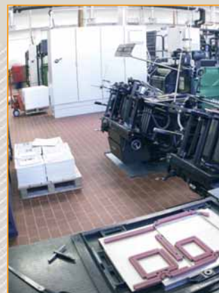
posadzka wykonana z płytek Argelith
